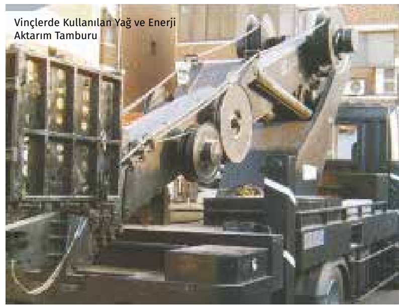
Vinçlerde Kullanılan Yağ ve Enerji Aktarım Tamburu
